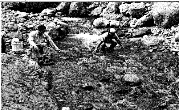
Foto 130. Aforo por método flotador sobre la quebrada el Hígado. 20 de agosto del 2019 a las 15:15 pm.
